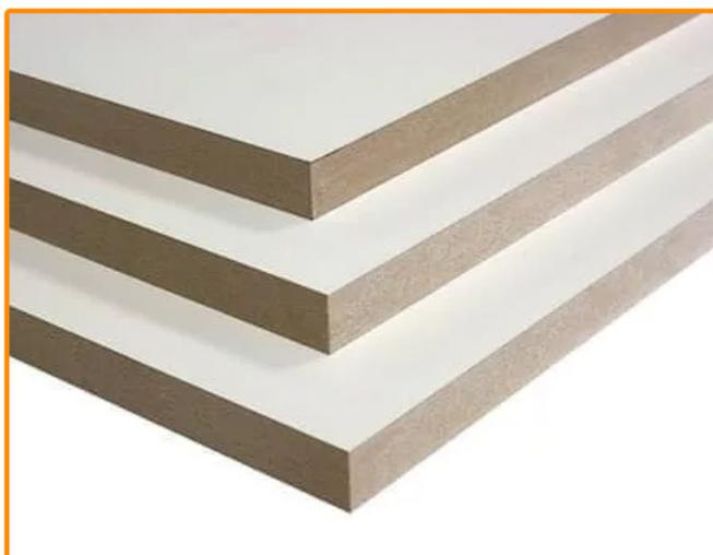
**МДФ. Medium Density Fibreboard (MDF)** переводится как «древесно-волокнистая плита средней плотности» (ДВП). Производится из опилок самых мелких частиц. Отличается от ЛДСП клеевым составом. Он с натуральными смолами лигнином и парафином. Это более плотный, влагостойкий, прочный и экологичный состав.
